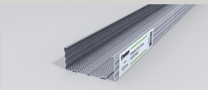
Профиль SoundGuard Strong ПП 60/27 имеет С-образное сечение и применяется совместно с направляющими профилями SoundGuard Strong ППН для формирования каркаса подвесных потолков и облицовок стен при внутренней отделке помещений и оформлении интерьеров с применением звукоизоляционных систем SoundGuard.
