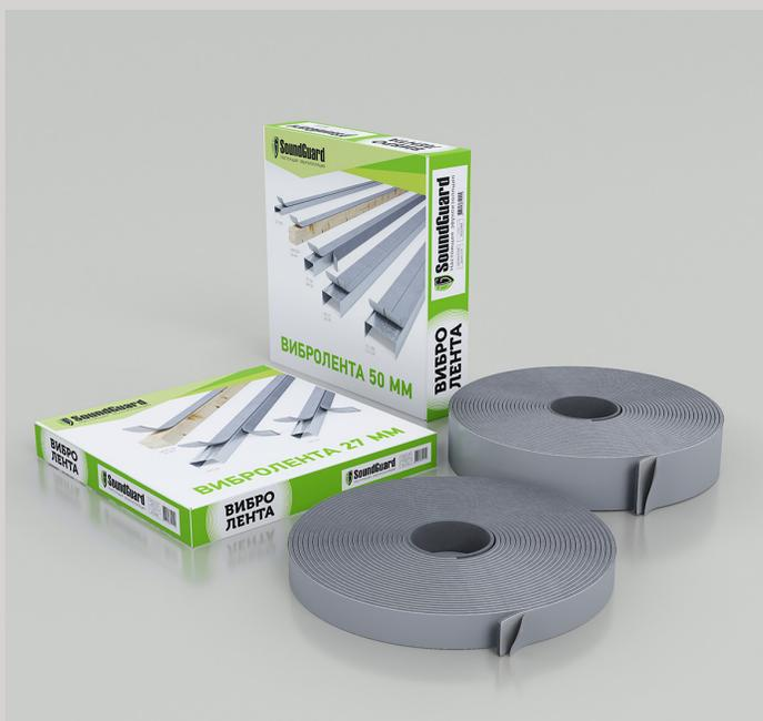
SoundGuard ВиброЛента – демпферная каучуковая лента, которая выполняет функцию вязкого вибродемпфирующего покрытия. Применяется для снижения передачи вибраций от ограждающих конструкций на металлический каркас. Одна сторона ленты имеет клеевую основу для удобства фиксации с металлическим профилем. Лента не дает усадки, устойчива к старению и воздействию атмосферы.
