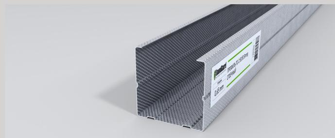
Профиль SoundGuard Strong ПС имеет С-образное сечение и применяется в качестве вертикальных стоек каркасов совместно с направляющими профилями SoundGuard Strong ПН для устройства перегородок при внутренней отделке помещений и оформлении интерьеров с применением звукоизоляционных систем SoundGuard.
