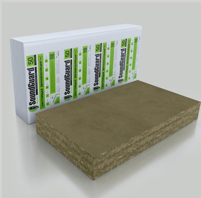
SoundGuard Basalt – звукопоглощающая плита из высококачественной каменной ваты на основе базальтовых пород. Благодаря волокнистой структуре обладает сквозной пористостью, что обеспечивает хорошие звукопоглощающие свойства. Звукопоглощающая плита Basalt является экологически чистым и негорючим материалом. Имеет неограниченный срок хранения и не подвергается гниению.
