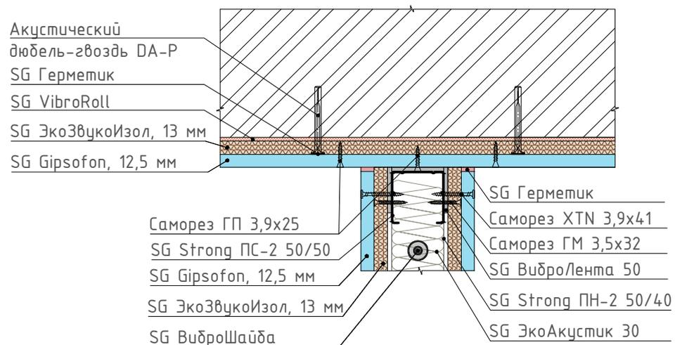
17 Узел сопряжения бескаркасных систем звукоизоляции стен (наружный угол)
