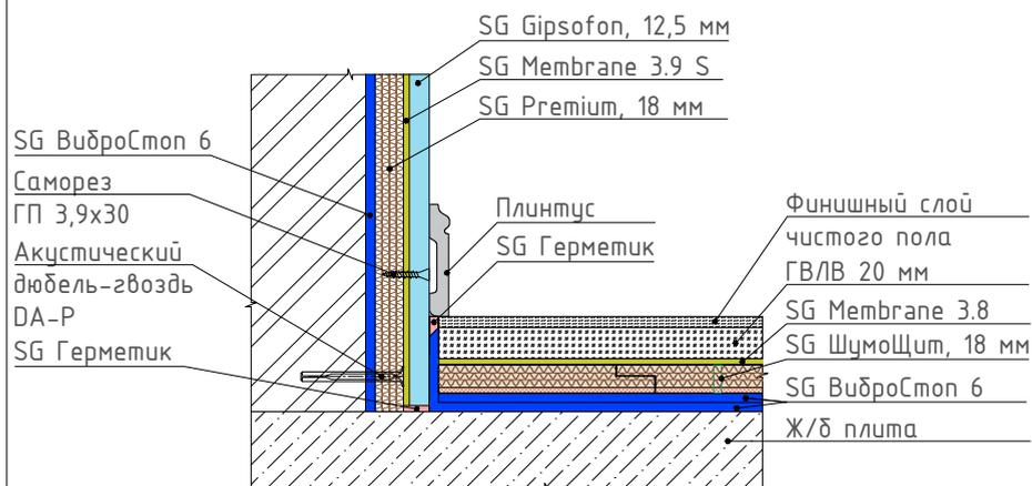
5 Узел сопряжения конструкции звукоизоляционной перегородки с системами звукоизоляции пола под финишное покрытие и пола под стяжку
