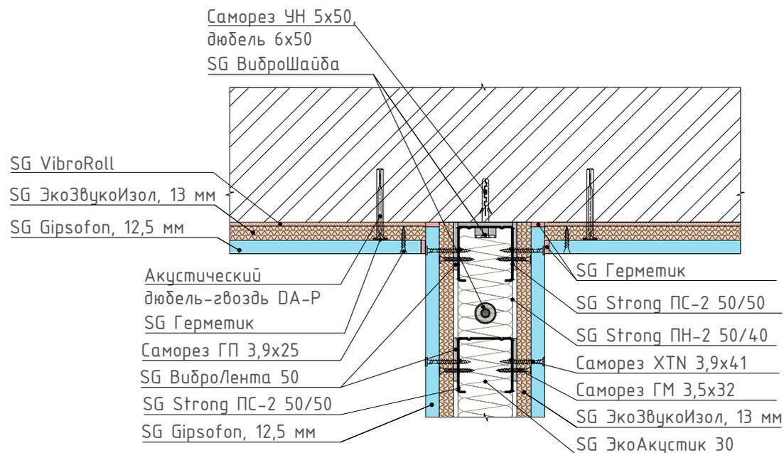
16 Узел примыкания конструкции звукоизоляционной перегородки к бескаркасной системе звукоизоляции стены
