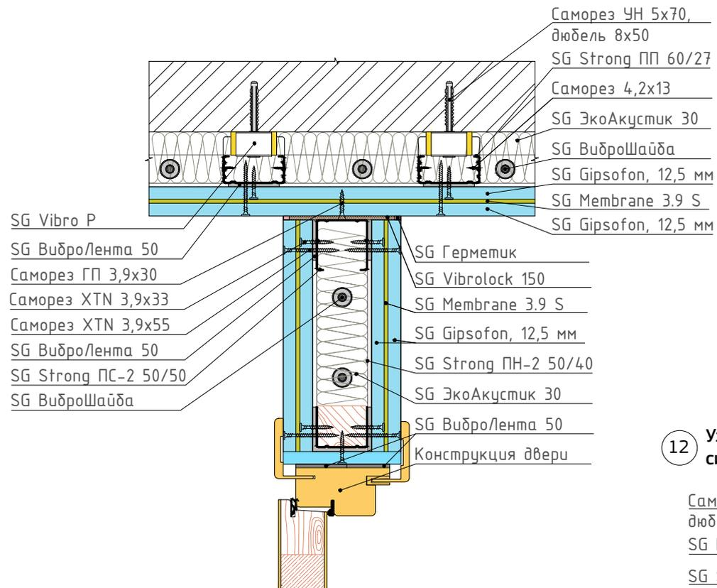
11 Узел сопряжения каркасных систем звукоизоляции стен (наружный угол)
