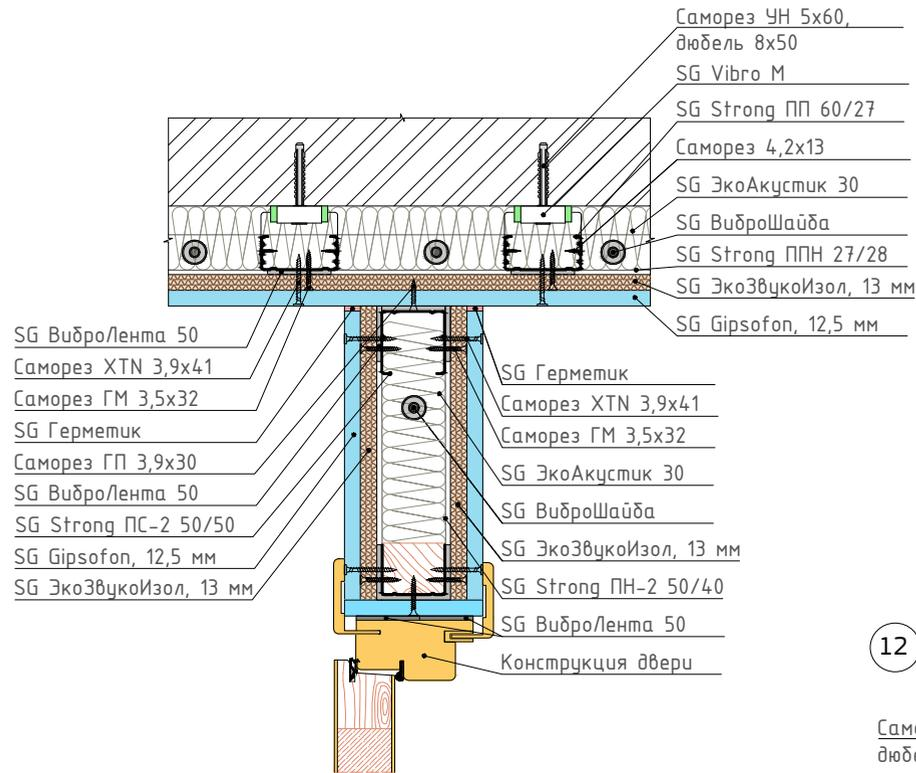
11 Узел сопряжения каркасных систем звукоизоляции стен (наружный угол)
