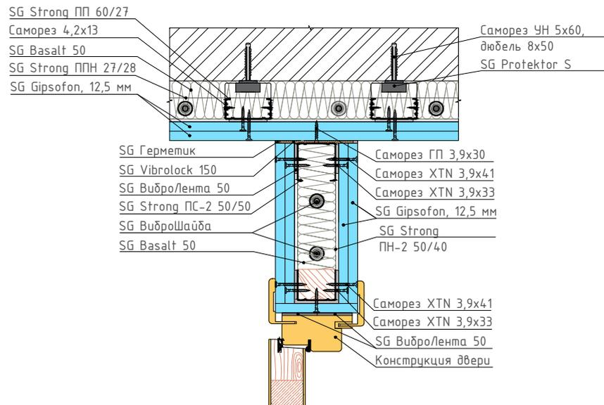
11 Узел сопряжения каркасных систем звукоизоляции стен (наружный угол)
