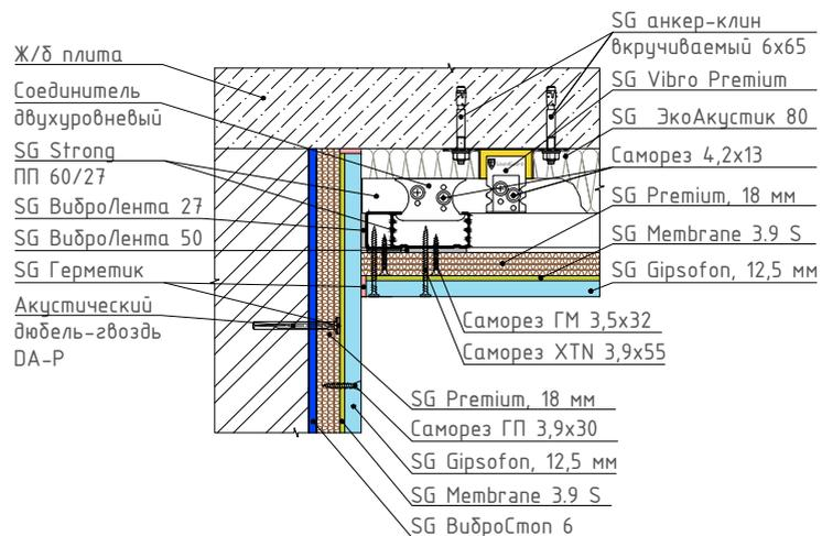
2 Узел сопряжения системы звукоизоляции потолка с конструкцией звукоизоляционной перегородки
