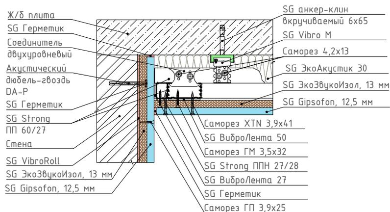
2 Узел сопряжения системы звукоизоляции потолка с конструкцией звукоизоляционной перегородки
