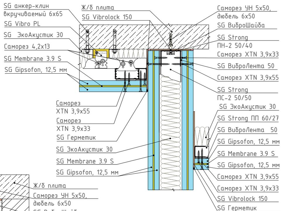
3 Узел сопряжения системы звукоизоляции потолка с конструкцией звукоизоляционной перегородки
