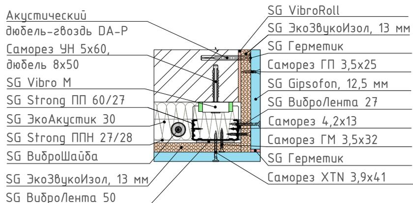
14 Узел сопряжения бескаркасных систем звукоизоляции стен (внутренний угол)
