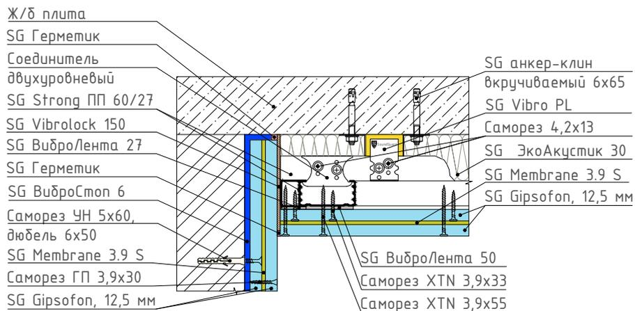
2 Узел сопряжения системы звукоизоляции потолка с бескаркасной системой звукоизоляции стены
