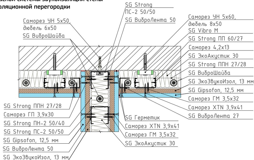
10 Узел примыкания конструкции звукоизоляционной перегородки к каркасной системе звукоизоляции стены
