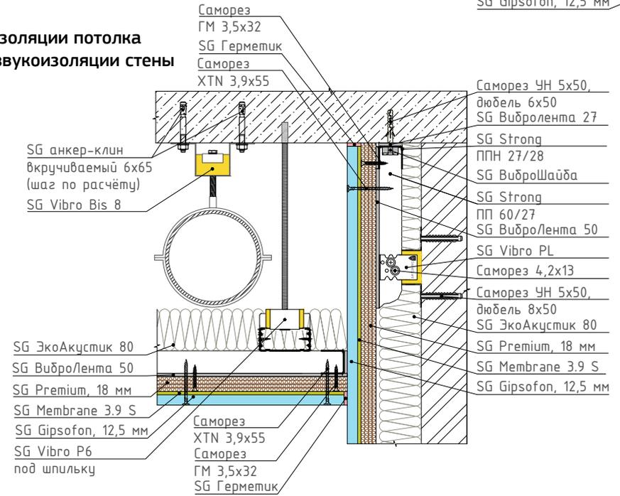
4 Узел сопряжения бескаркасной системы звукоизоляции стены с системой звукоизоляции пола под финишное покрытие
