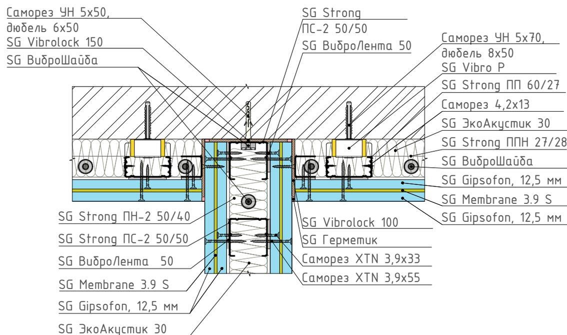
10 Узел примыкания конструкции звукоизоляционной перегородки к каркасной системе звукоизоляции стены
