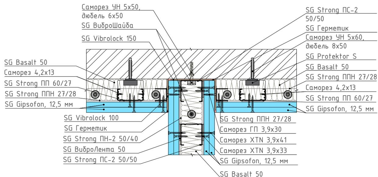
10 Узел примыкания конструкции звукоизоляционной перегородки к каркасной системе звукоизоляции стены
