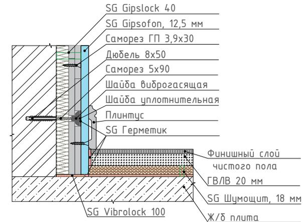
3 Узел сопряжения системы звукоизоляции потолка на отnose с бескаркасной системой звукоизоляции стены
