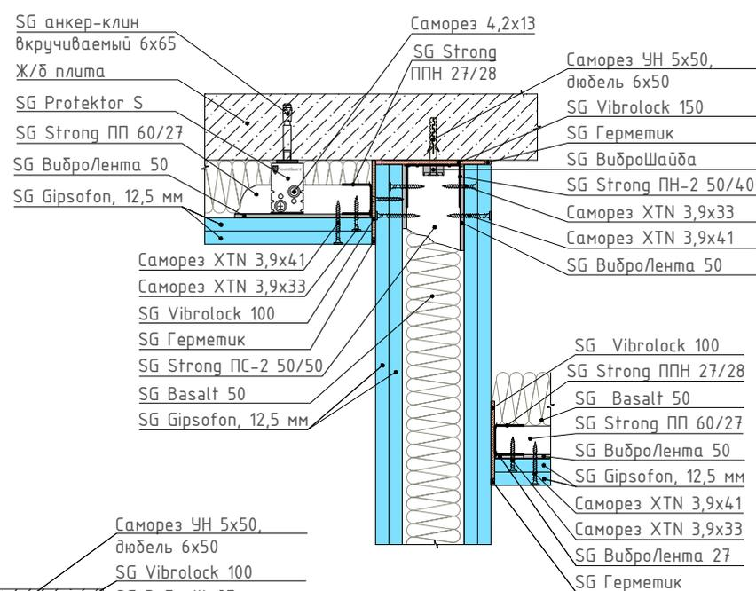
3 Узел сопряжения системы звукоизоляции потолка с каркасной системой звукоизоляции стены
