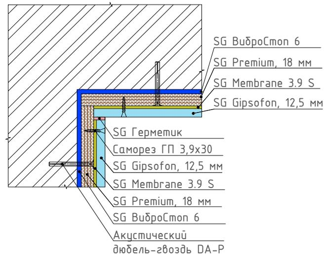
15 Узел примыкания бескаркасной системы звукоизоляции стены к конструкции звукоизоляционной перегородки
