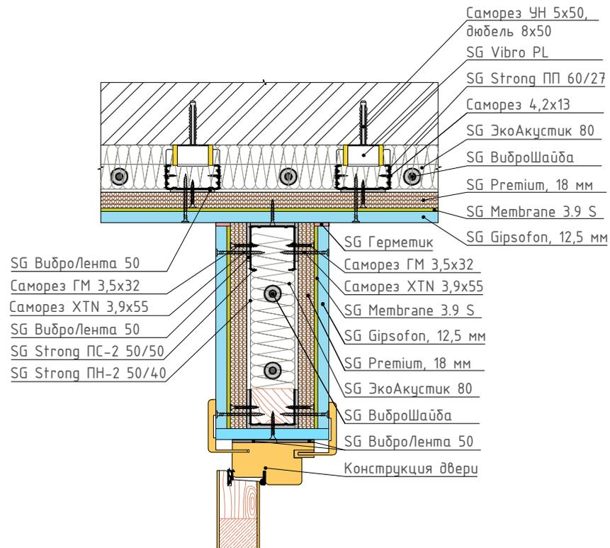
11 Узел сопряжения каркасных систем звукоизоляции стен (наружный угол)
