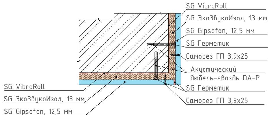
18 Узел сопряжения бескаркасной системы с каркасной системой звукоизоляции стены (внутренний угол)
