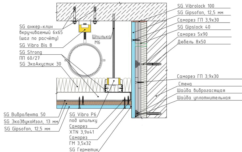
4 Узел сопряжения бескаркасной системы звукоизоляции стены с системой звукоизоляции пола под стяжку
