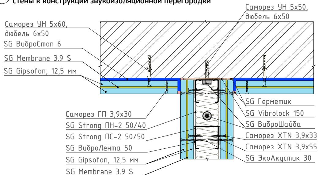
16 Узел примыкания конструкции звукоизоляционной перегородки к бескаркасной системе звукоизоляции стены
