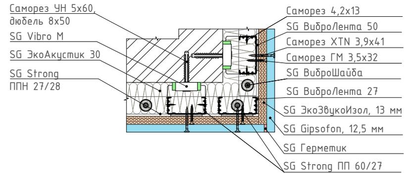
12 Узел сопряжения каркасной системы с бескаркасной системой звукоизоляции стены (внутренний угол)
