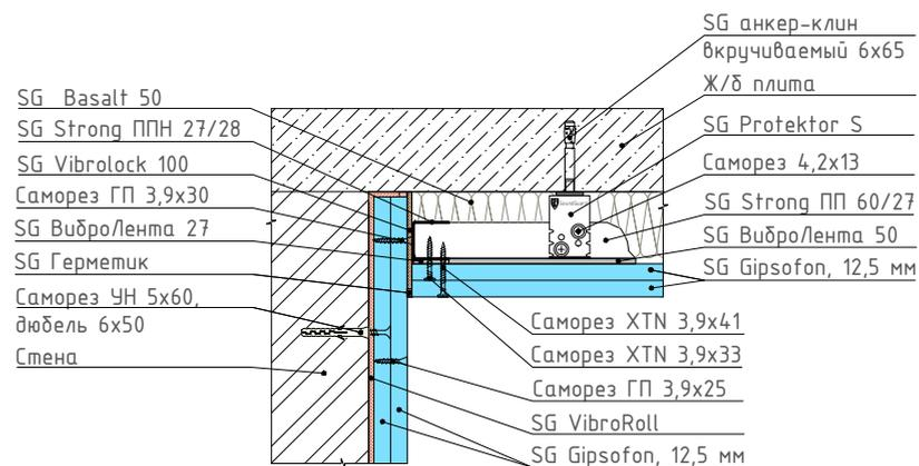
2 Узел сопряжения системы звукоизоляции потолка с конструкцией звукоизоляционной перегородки
