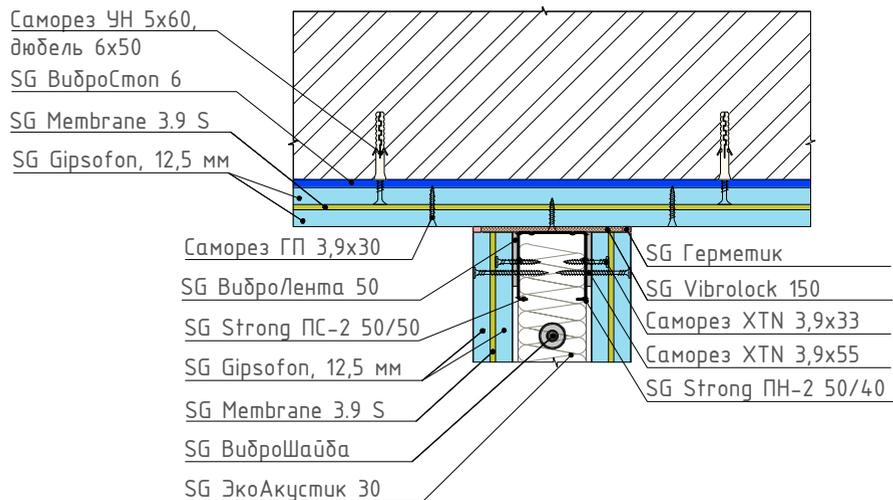
17 Узел сопряжения бескаркасных систем звукоизоляции стен (наружный угол)
