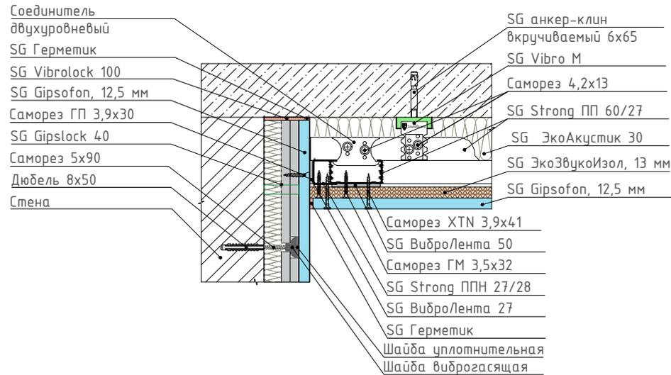
2 Узел сопряжения бескаркасной системы звукоизоляции стены с системой звукоизоляции пола под финишное покрытие
