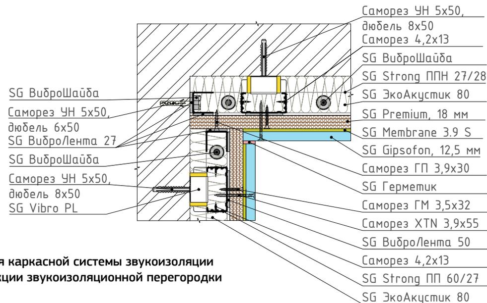
9 Узел примыкания каркасной системы звукоизоляции стены к конструкции звукоизоляционной перегородки
