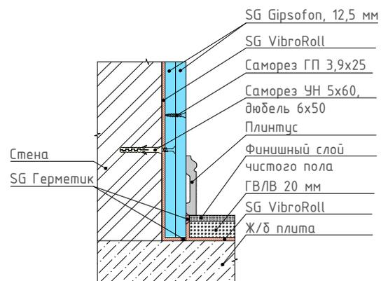
5 Узел сопряжения конструкции звукоизоляционной перегородки с системами звукоизоляции пола под финишное покрытие и пола под стяжку
