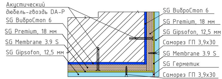
18 Узел сопряжения бескаркасной системы с каркасной системой звукоизоляции стены (внутренний угол)
