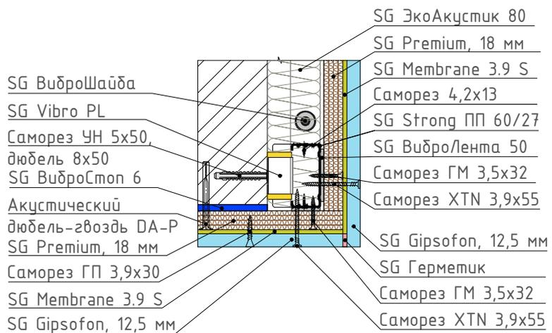
8 Узел сопряжения каркасных систем звукоизоляции стен (внутренний угол)
