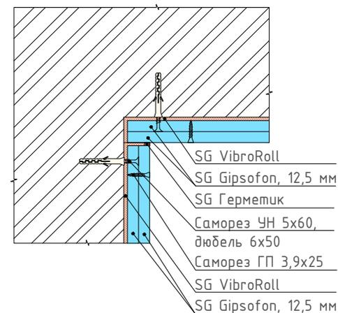
15 Узел примыкания бескаркасной системы звукоизоляции стены к конструкции звукоизоляционной перегородки
