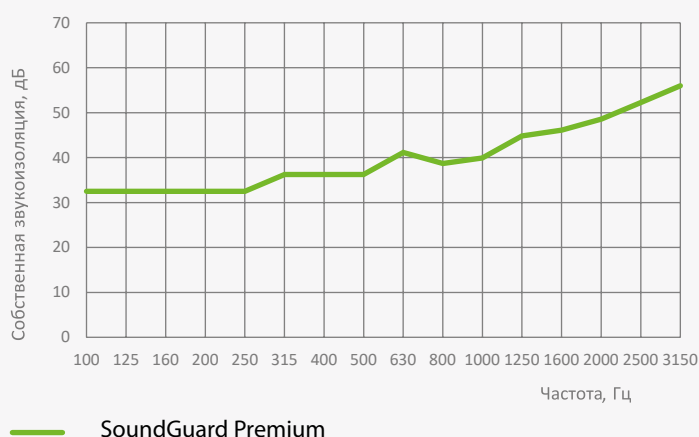
График собственной звукоизоляции воздушного шума SoundGuard Premium (измерено)
