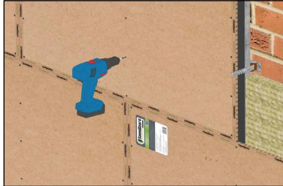
**6** Шляпка самореза слегка утапливается и изолируется от прямого соприкосновения с облицовочным листом с помощью герметика **SoundGuard Seal**.
