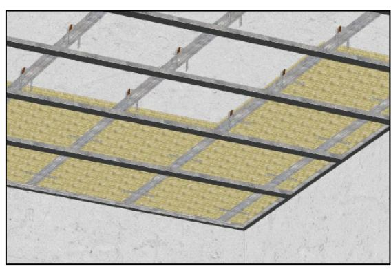
**7** Саморезами ГМ 3,5×25 к каркасу крепятся звукоизолационные панели **SoundGuard**. Каркас обшивается панелями вразбежку по отношению к предыдущему ряду, вплотную к стенам.
