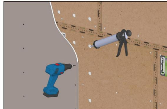
**9** Финишный слой ГКЛ крепится универсальными саморезами 5 × 45 с усилением соединения к гипсоволокнистому листу при помощи точечного нанесения герметика **SoundGuard Seal**. При этом важно избегать попадания саморезов в металлический каркас конструкции.
