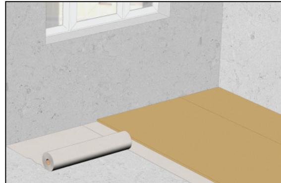
**2** Поверх демпферной подложки укладываются звукоизоляционные панели **SoundGuard**, кромка к кромке, впритык к стенам, вразбежку, без зазоров.
