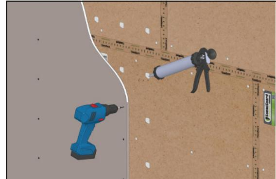
**9** Финишный слой крепится универсальными саморезами  $5 \times 45$  к гипсоволокнистому листу с усилением соединения при помощи точечного нанесения герметика **SoundGuard Seal**. При этом важно избегать попадания саморезов в металлический каркас конструкции.
