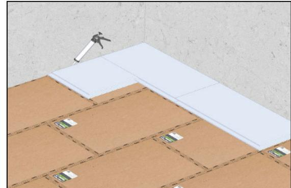
**4a** Кафельная плитка монтируется на подготовленную поверхность согласно рекомендациям производителя плитки. Между кафельной плиткой и стеной необходимо оставить зазор величиной 4 мм, который нужно заполнить герметиком **SoundGuard Seal**.
