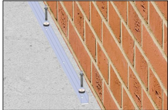
**3** Боковая стенка направляющего профиля и торец потолочного профиля проклеиваются демпферной лентой **SoundGuard Band Rubber**.
