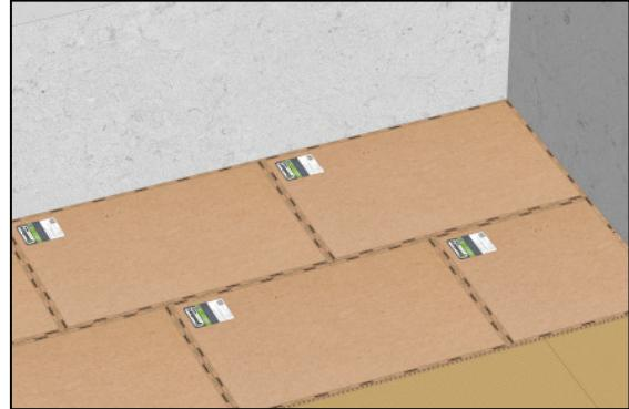
**3** Швы между панелями и стыки со стенами заполняются герметиком **SoundGuard Seal** и проклеиваются самоклеющейся лентой **SoundGuard Tape**. Ламинат и паркетная доска системы монтируются непосредственно на панели **SoundGuard** либо в соответствии с рекомендациями производителя.
