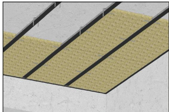
**6** Саморезами ГМ 3,5 × 25 к каркасу крепятся звукоизоляционные панели **SoundGuard**. Каркас обшивается панелями вразбежку по отношению к предыдущему ряду, вплотную к стенам.
