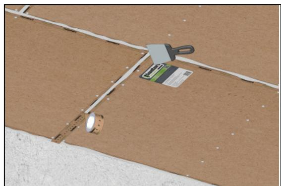
**9** Финишная облицовка конструкции производится двумя слоями: первый слой из гипсоволокнистого или гипсокартонного листа, второй – из гипсокартонного листа. Первый облицовочный лист крепится саморезами ГМ 3,5 × 35 к профилю каркаса с усилением соединения с помощью точечного нанесения герметика **SoundGuard Seal**.
