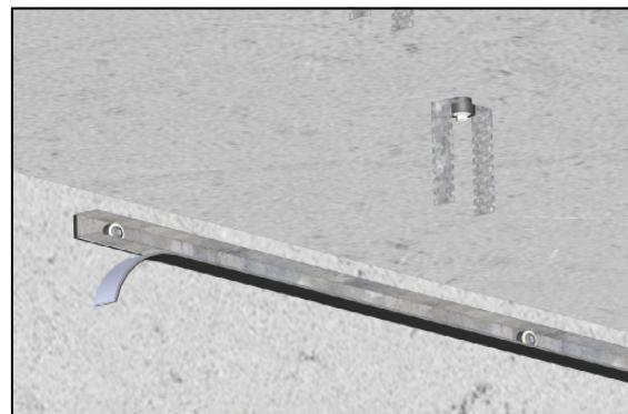
**4** Торец потолочного профиля проклеивается демпферной лентой **SoundGuard Band Rubber**. Потолочные профили устанавливаются с шагом 400–600 мм.
