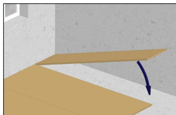
**2** Поверх демпферной прослойки укладываются панели **SoundGuard**, кромка к кромке, впритык к стенам, вразбежку, без зазоров.
