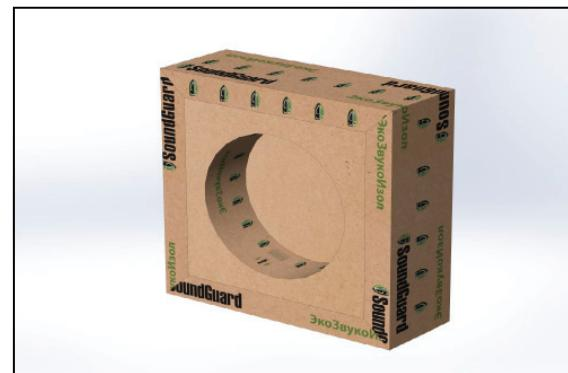
**11** Отверстие под гнездо вырезается заранее в горизонтально расположенной панели, край спила обрабатывается герметиком **SoundGuard Seal** или заклеивается самоклеющейся лентой **SoundGuard Tape**.
