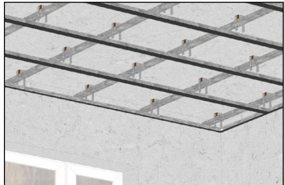
**5** После монтажа каркаса из направляющих профилей удаляются дюбель-гвозди.
