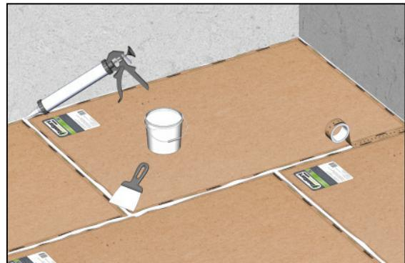
**4** Между финишным покрытием пола и стеной необходимо оставить зазор величиной 4 мм, который нужно заполнить герметиком **SoundGuard Seal**.
