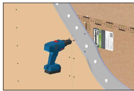
**10** В звукоизоляционных каркасно-обшивных конструкциях гнёзда для розеток, выключателей и точечных светильников помещают в короб **SoundGuard IzоБox**.
