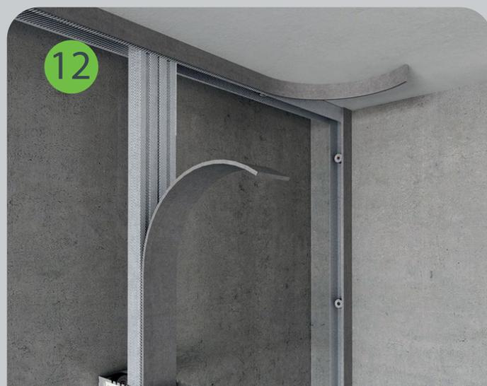
Направляющие профили проклеиваются демпферной лентой SoundGuard ВиброЛента 27. Потолочные профили проклеиваются демпферной лентой SoundGuard ВиброЛента 50.
