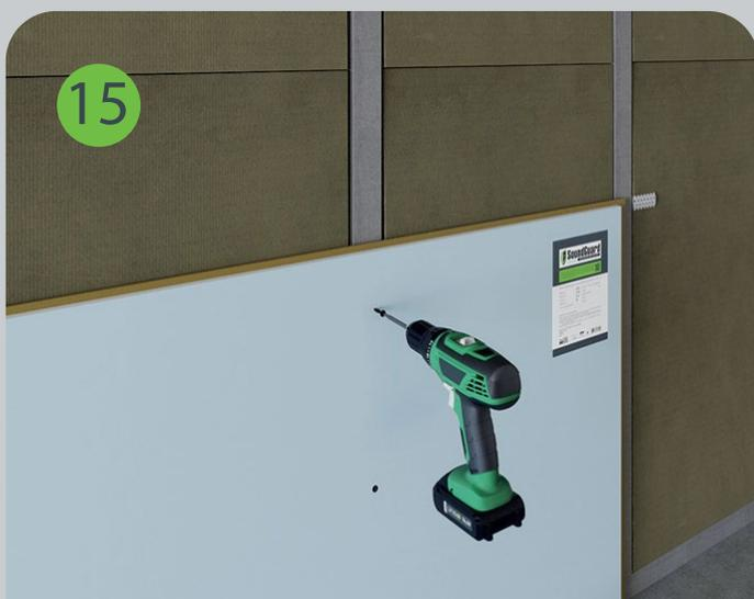
Гипсокартон Gipsophon монтируется совместно с мембраной и крепится к профилю без зазоров между листами саморезами SoundGuard XTN 3,9x33. Расход составляет не менее 17 шт./м<sup>2</sup>. Шляпки саморезов слегка утапливаются.
