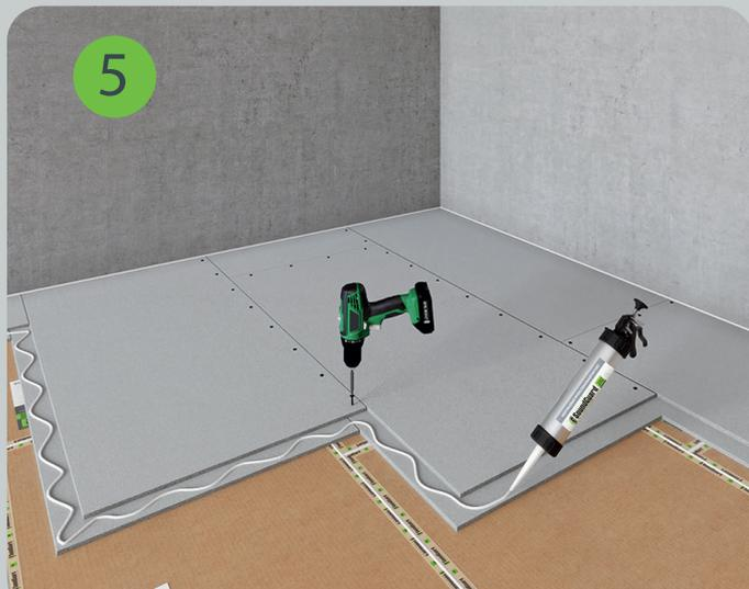
В процессе монтажа элементов пола KNAUF Суперпол или аналога места соединения листов заполняются звукоизоляционным герметиком SoundGuard Seal. Листы соединяются между собой саморезами длиной не более 20 мм.
