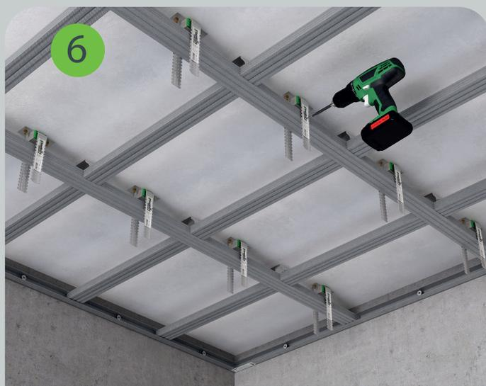
Потолочные профили SoundGuard Strong ПП 60/27 крепятся к виброизоляционным подвесам. Шаг профилей составляет 600 мм в одном направлении и 400 мм – в перпендикулярном. Ячейки каркаса должны иметь размеры 400 x 600 мм.
