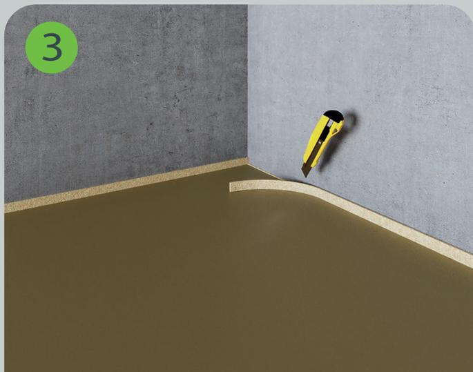
После монтажа звукоизоляционных мембран излишки виброакустической подложки SoundGuard VibroRoll удаляются.
