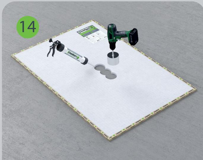
Отверстие под гнездо розетки или выключателя вырезается заранее в горизонтально расположенной панели SoundGuard Premium и промазывается виброакустическим герметиком SoundGuard 310.
