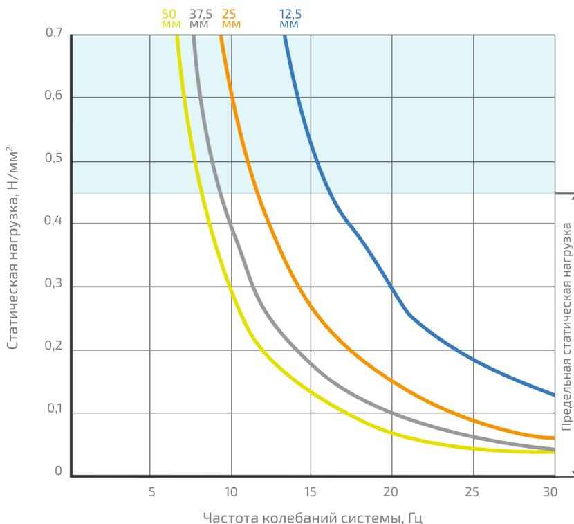
Собственная частота системы с одной степенью свободы, состоящей из массы и виброизолирующего слоя GENER VX 450 на неподвижном основании.
