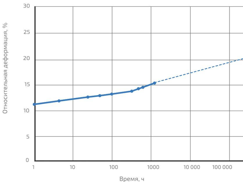
Испытание проведено между двумя плоскопараллельными стальными пластинами. Методика измерения разработана на основе стандарта ГОСТ EN1606-2011. Экстраполяция на 50 лет (438000 ч) данных деформации, полученных в течение 44 суток.
