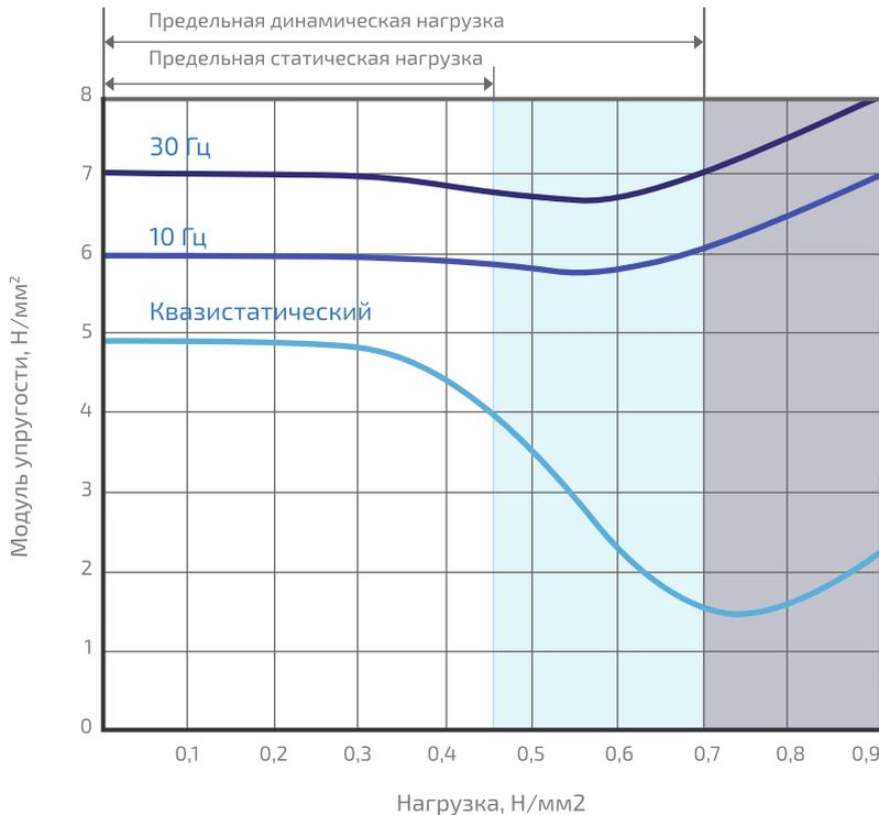
Квазистатический модуль упругости рассчитан из данных нагрузка-деформация статических испытаний. Динамический модуль упругости измерен с амплитудой 0.2 мм для 10 Гц и 0.1 мм для 30 Гц. Измерения проведены в соответствии со стандартом DIN 53513.
