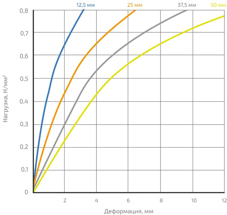
Испытание проведено путем сжатия образца между двумя стальными плоскопараллельными пластинами по стандарту ISO 844. Скорость сжатия 10% деформации образца в мин.
