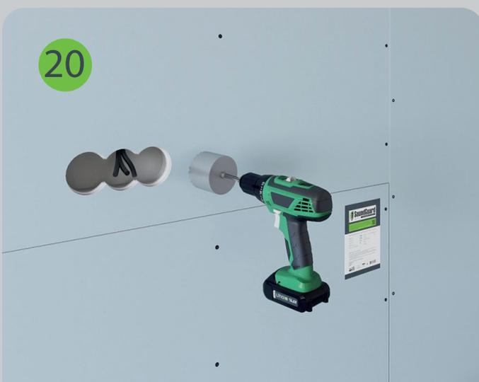
После монтажа звукоизоляционного гипсокартона SoundGuard Gipsofon в нем коронкой просверливается отверстие в месте установки подрозетника. В звукоизоляционном подрозетнике SoundGuard ИзоБокс Премиум монтируется электрический подрозетник, который прикручивается саморезами к внутренней плоскости короба.
