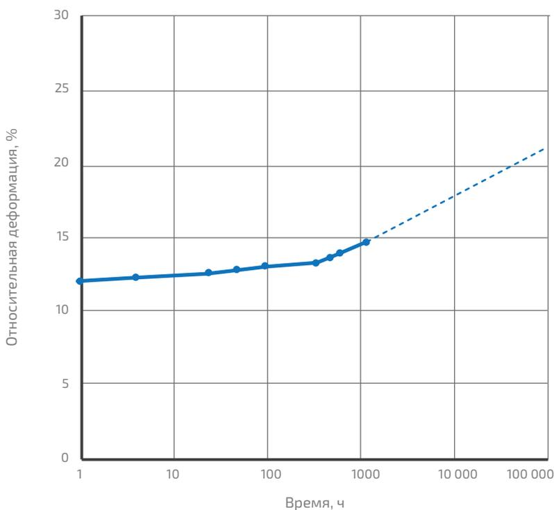
Испытание проведено между двумя плоскопараллельными стальными пластинами. Методика измерения разработана на основе стандарта ГОСТ EN1606-2011. Экстраполяция на 50 лет (438000 ч) данных деформации, полученных в течение 44 суток.
