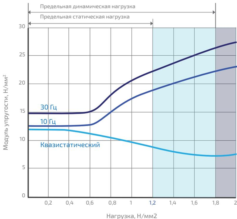
Квazистатический модуль упругости рассчитан из данных нагрузка-деформация статических испытаний. Динамический модуль упругости измерен с амплитудой 0.2 мм для 10 Гц и 0.1 мм для 30 Гц. Измерения проведены в соответствии со стандартом DIN 53513.
