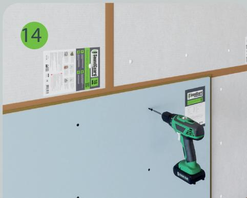
Звукоизоляционный гипсокартон SoundGuard Gipsosfon монтируется совместно с мембраной и крепится к поверхности звукоизоляционных панелей саморезами SoundGuard ГП 3,9х30.
