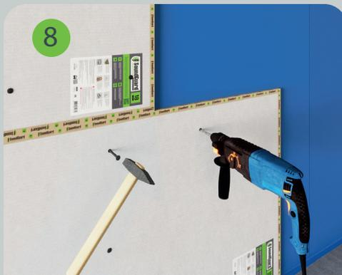
Акустические дюбель-гвозди забиваются в предварительно просверленные (сквозь панель) отверстия в стене и утапливаются в теле панели на 1 мм. На одну звукоизоляционную панель требуется не менее 12 дюбель-гвоздей SoundGuard DA-P.
