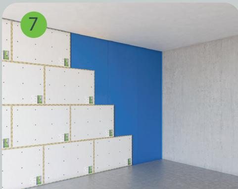
Звукоизоляционные панели SoundGuard Premium устанавливаются вразбежку и крепятся к стене с помощью акустических дюбель-гвоздей SoundGuard DA-P.
