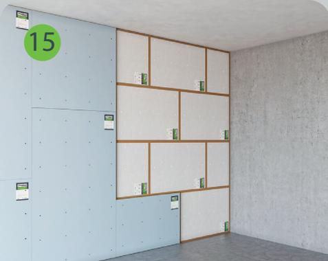
Звукоизоляционный гипсокартон SoundGuard Gipsosfon монтируется без зазоров между листами. Расход саморезов SoundGuard ГП 3,9х30 составляет не менее 22 шт./м<sup>2</sup>.
