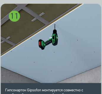
Гипсокартон Gipsofon монтируется совместно с мембраной и крепится к профилю без зазоров между листами саморезами SoundGuard XTN 3,9x33. Расход составляет не менее 17 шт./м². Шляпки саморезов слегка утапливаются.
