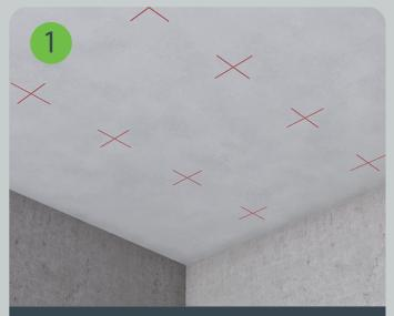
Выполняется разметка потолка для установки виброизоляционных креплений SoundGuard. Шаг подвесов вдоль потолочного профиля SoundGuard Strong ПП 60/27 составляет 450-600 мм, в перпендикулярном направлении – 600 мм и соответствует шагу потолочных профилей SoundGuard Strong ПП 60/27.\*
