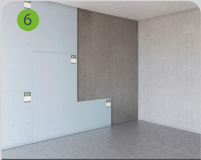
Звукоизоляционный гипсокартон монтируется совместно с мембраной и крепится к стене без зазоров между листами.
