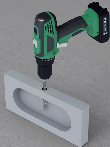
В звукоизоляционном подрозетнике SoundGuard ИзоБокс Стандарт просверливается отверстие для выпуска проводов. Место выхода электропровода заполняется герметиком SoundGuard Seal.
