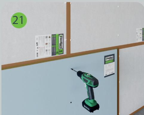
Гипсокартон Gірsofoп монтируется совместно с мембраной и крепится к профилю без зазоров между листами саморезами SoundGuard XTN 3,9x41. Расход составляет не менее 17 шт./м<sup>2</sup>. Шляпки саморезов слегка утапливаются.
