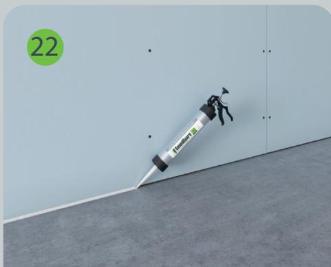
Между торцами листов гипсокартона и поверхностями пола, стен и потолка остается зазор 3 – 5 мм, который заполняется герметиком SoundGuard Seal.
