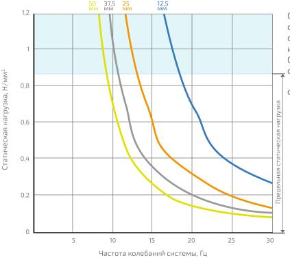
Собственная частота системы с одной степенью свободы, состоящей из массы и виброизолирующего слоя GENER VX 850 на неподвижном основании.
