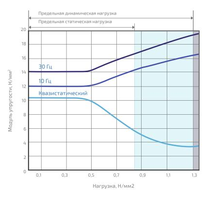
Квазистатический модуль упругости рассчитан из данных нагрузка-деформация статических испытаний. Динамический модуль упругости измерен с амплитудой 0.2 мм для 10 Гц и 0.1 мм для 30 Гц. Измерения проведены в соответствии со стандартом DIN 53513.
