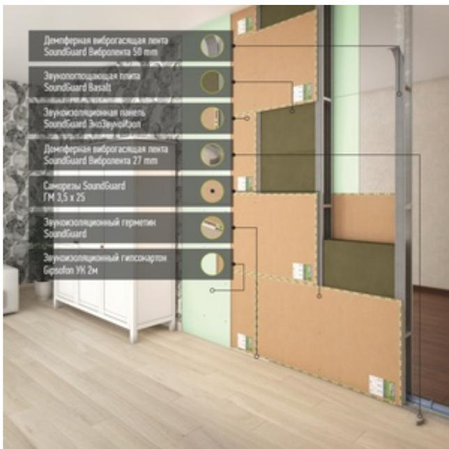
Материалы для каркасной звукоизоляции межкомнатной перегородки в гостинице -  $RW = 56-60$  дБ. Инженеры завода звукоизоляционных материалов "SoundGuard" выбрали лучшие материалы для звукоизоляции гостиничной перегородки и просчитали точное количество необходимых материалов.
