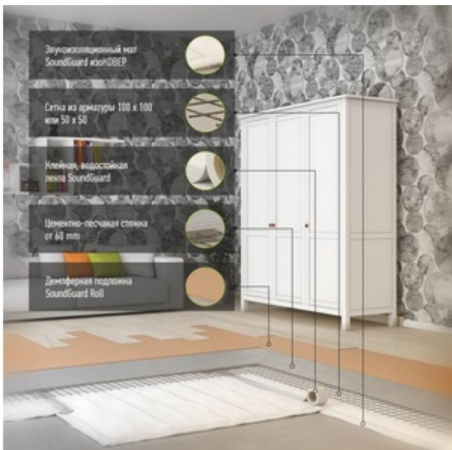
Звукоизоляция стяжки пола по системе "Стандарт+",  $L_{nw}$  34 дБ
